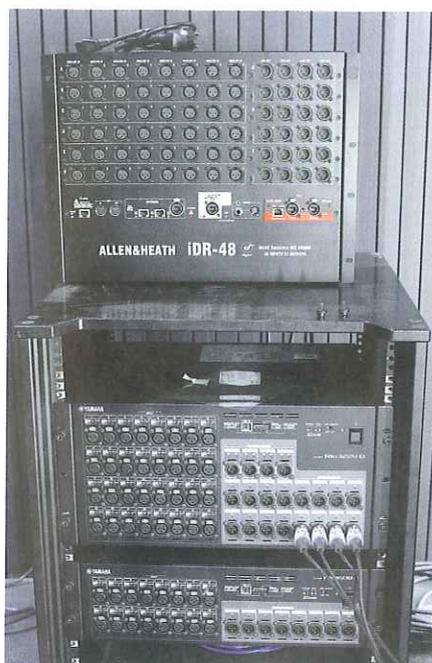
Stage Box Yamaha E/S Rio3224-D et Yamaha E/S Rio1608-D (en bas) ; mix-rack Allen & Heath IDR-48 (posé dessus)
